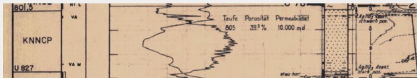
Reservoireigenschappen van de boring Schoonebeek-03: wederom van zeer goede kwaliteit. De zgn. DrillStemTest/ DST produceerde in 20 minuten 300 liter olie [Wellog SCH-03].
